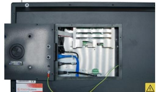
Einblick in die geöffnete Rückwand-Klappe die auch Tragarm-Adapter ist.
